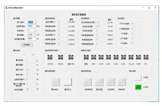
软件有串口配置、高压参数监控、射线管监控、电压监控、曝光监测、高压电源状态指示、故障状态指示、曝光启停控制、高压电源控制以及焦点选择。
